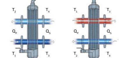
В редком случае подача и потребность хорошо скомпенсированы. Это идеальная ситуация, при которой гидрострелка в действительности лишняя.
