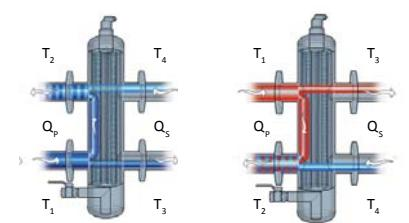
В этой ситуации подача выше потребности. Это приведет к уменьшению разности  $\Delta T$  T<sub>1</sub> и T<sub>2</sub>. Некоторая часть воды подачи будет включена в обратную воду, в результате чего снизится эффективность нагревателя или охладителя. По возможности нужно отрегулировать мощность в меньшую сторону.
